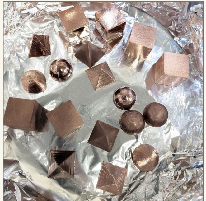
↑ Primi test di elettroplaccatura.
